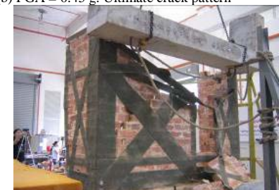
(d) PGA = 0.8 g: Another view of collapse
