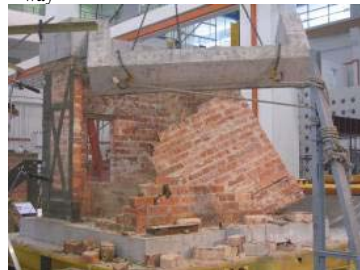
(d) PGA = 0.35 g: Total collapse
